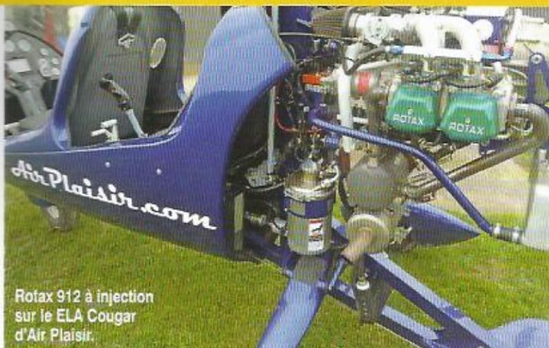
Rotax 912 à injection sur le ELA Cougar d'Air Plaisir.
