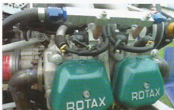
Rampes et injecteurs: notez les entretoises en matériau isolant qui empêchent l'échauffement par conduction du carburant dans les rampes.
