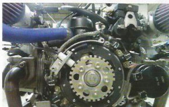
Gros plan sur le capteur PMH (Point Mort Haut) et sa roue dentée. Notez la dent manquante qui déclenche l'impulsion du capteur à chaque tour.
