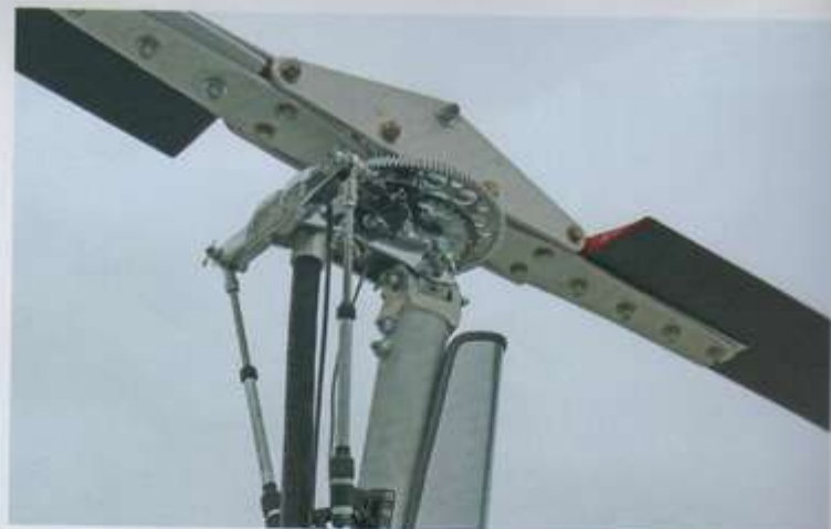
Gros plan sur la tête de rotor, du flexible de pré-lancement et des commandes de vol en push pull.
